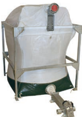
Abb. 15: Flachbodensilo mit Rührwerk und Schneckenausrag von unten
